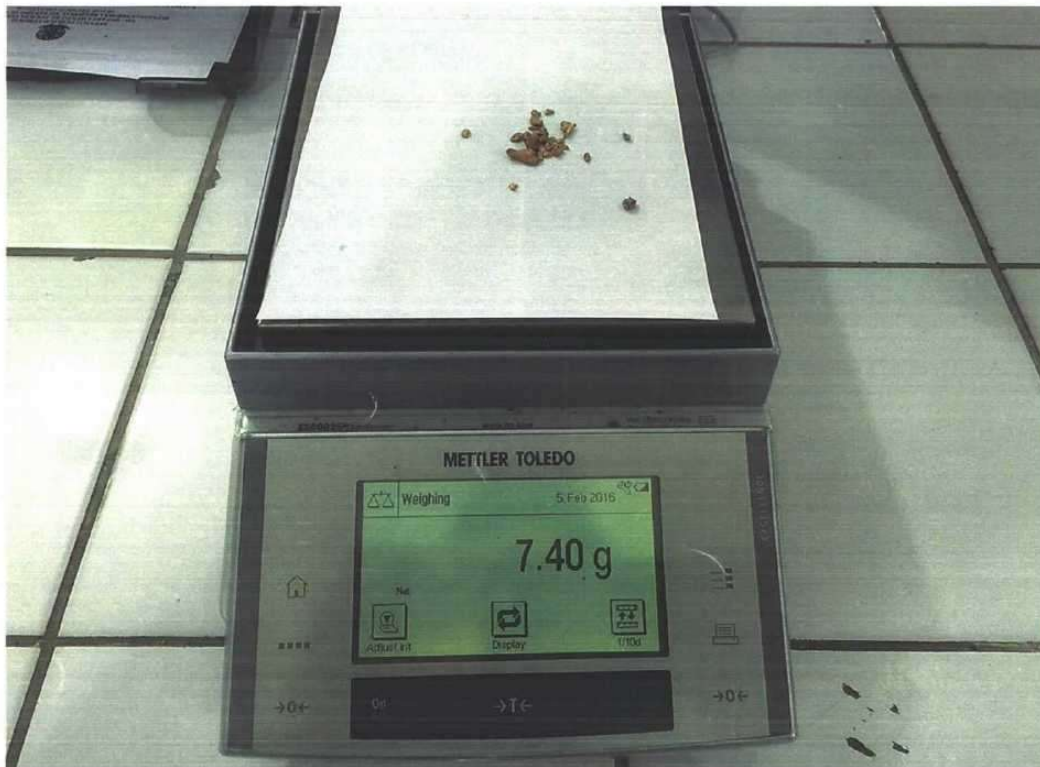
Figura 2 – Foto do material encaminhado para exame. Observe que o visor da balança indica a massa líquida do material examinado, a massa do papel e do frasco já estão descontadas.
